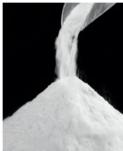
Bild 1. Das rieselfähige Polypropylenpulver eignet sich zur Verarbeitung auf den meisten gebräuchlichen Lasersinteranlagen
